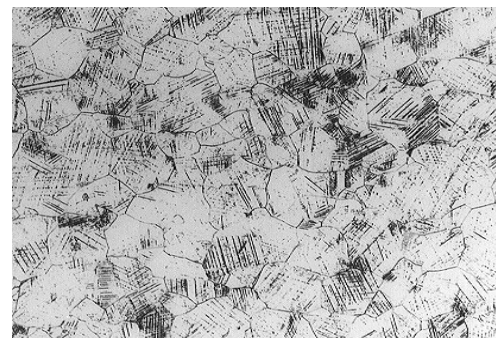
SUS 304 の冷間加工材の組織
